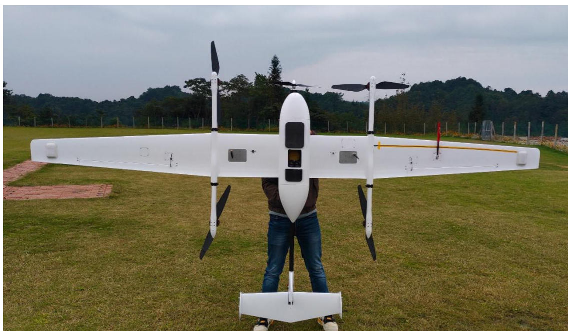
GTK-R15 航磁补偿测量系统集成于 CW-15 大鹏无人机
