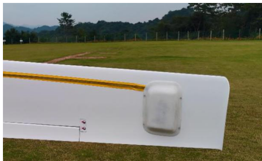
铷光泵航磁测量传感器集成于左机翼
