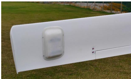
磁通门航磁补偿传感器集成于右机翼
