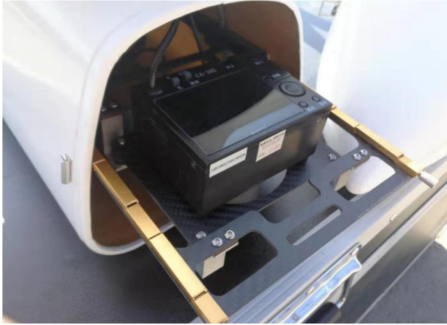
CA102 正射航测相机集成于 CW-15 大鹏无人机
