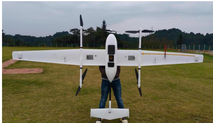
铷光泵/磁通门磁力仪双补偿系统集成于 CW-15 大鹏无人机
